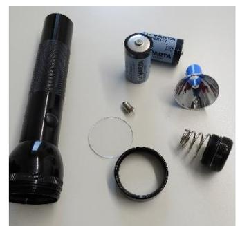
Bild 3: Bauteile einer Taschenlampe (Forscherstation)
